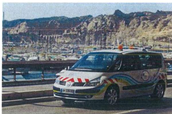
À vitesse réduite les « barbiches », des capteurs de méthane 10 000 fois plus sensibles que le nez humain, recueillent les informations qui s'affichent sur l'ordinateur du technicien à l'arrière du véhicule. En cas de présence suspecte de méthane, le technicien procède à des analyses complémentaires et fait appel au besoin à une équipe d'intervention.
