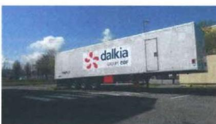
Il s'agit d'une chaufferie mobile. C'est une installation autonome de chauffage disposée dans une semi-remorque. Elle est destinée à palier d'éventuelles pannes ou à pouvoir opérer des coupures de chauffage et d'eau chaude. La puissance thermique maximale de l'UMPC est de 2 000 kW. Des piquages pour son raccordement rapide ont été réalisés pour les sous-stations du Centre Hospitalier Saint Charles ainsi que du Centre Aqualudique AquaNova America.
